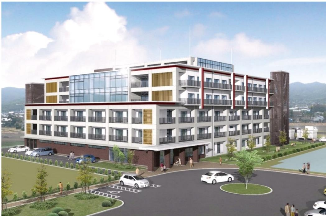
オー・ド・エクラでは、外皮性能を強化したパッシブ設計を取り入れ、地中熱ヒートポンプを利用した空調・給湯設備を採用し、エネルギー負荷低減を図っています。制御付きLED照明設備やBEMS装置や高効率熱源を導入し、ZEB化の実現を目指しています。
