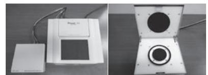
図2 高抵抗率計(本体、電極)
